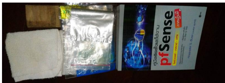
รูปที่ 7 วัสดุต่างๆที่นำความหนามาใช้ในการทดสอบประสิทธิภาพการระบุตัวตนแท็กของเครื่องอ่านอาร์เอฟไอดี ได้แก่ ไม้ กระดาษ พลาสติก และผ้า
