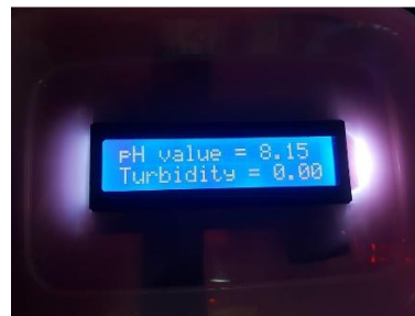
รูปที่ 8 จอ LCD แสดงค่า pH value ที่วัดได้
