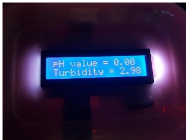
รูปที่ 7 จอ LCD แสดงค่า Turbidity ที่วัดได้
